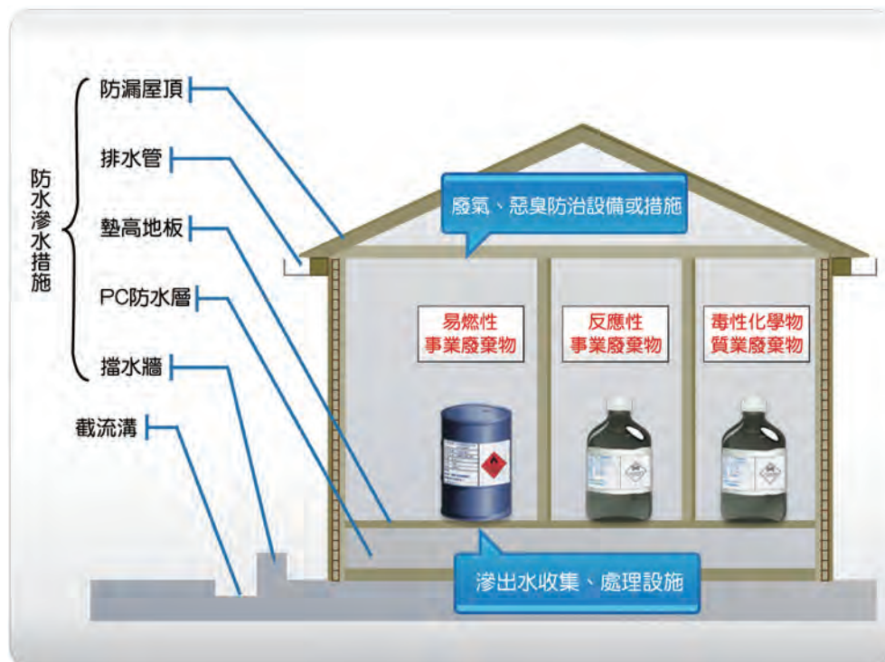
圖 2.3-6 有害廢棄物貯存設施防漏及污染防制措施示意圖
